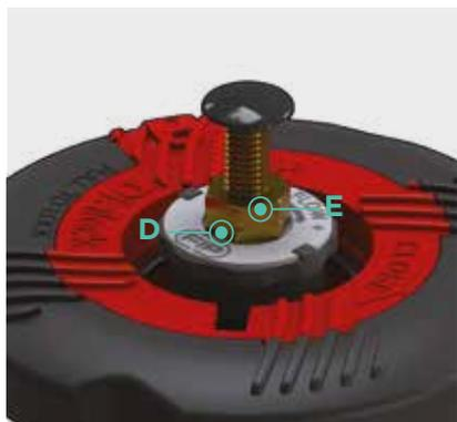
La valvola a membrana in versione DKL è dotata di un sistema di regolazione della corsa del volante che consente di variare la portata massima e minima della valvola e di preservare la membrana da una compressione eccessiva in fase di chiusura.
