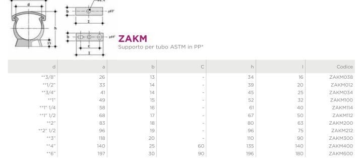
\*per la supportazione del tubo fare riferimento alla linea guida riportata nella DVS 2210-1 (Planning and execution above-ground pipe system)
