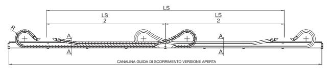
Le fiancate della canalina guida di scorrimento vengono fornite in kit di montaggio composto da: Fiancate laterali lunghezza standard di mm 2000. Squadre di giunzione Viteria di fissaggio
