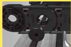
Apertura facilitata del perno di giunzione.
